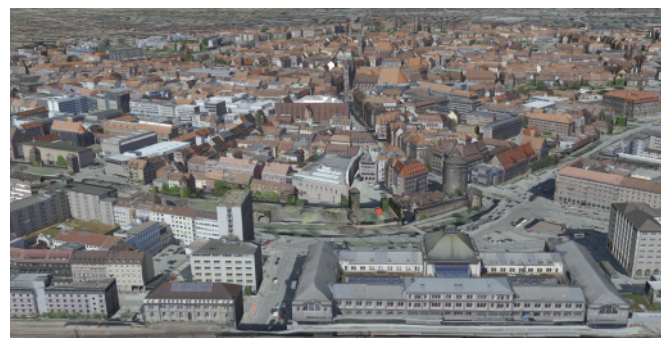
Fotorealistische Texturierung aus Schrägsichtluftbildern oder Stereoluftbildern mit hoher Überlappung (vollautomatisch)
